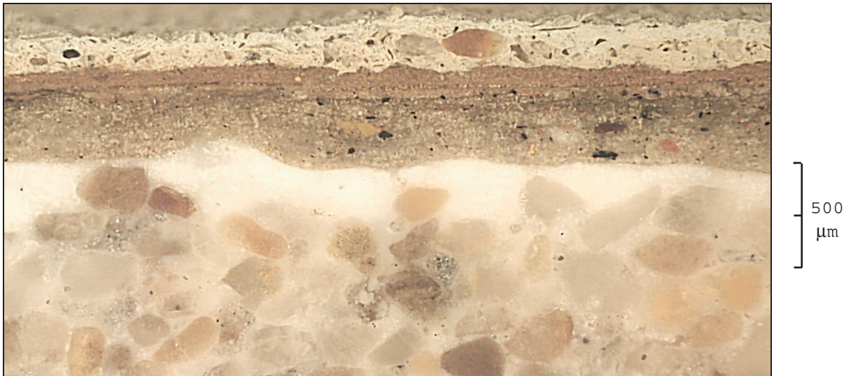
Sezione lucida trasversale, luce riflessa, 40 ingrandimenti.
